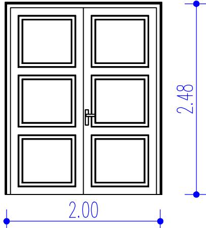
Dvokrilna lesena masivna notranja vrata, izdelana iz smrekovega lesa (bela barva), v lesenem plohestem podboju, v obstoječem zidu, zidna odprtina je velikosti 200 / 248cm. Vrata so izdelana po vzoru primarnih vrat in morajo biti v skladu z ZVKDS.
