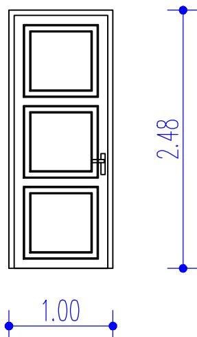
Enokrilna lesena masivna notranja vrata, izdelana iz smrekovega lesa (bela barva), v lesenem plohestem podboju, v obstoječem zidu, zidna odprtina je velikosti 100 / 248cm. Vrata so izdelana po vzoru primarnih vrat in morajo biti v skladu z ZVKDS.
